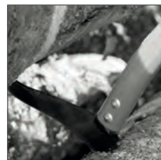
FOGAZÁS A FAGYOTT FÁBAN VALÓ JOBB FOGÁS ÉRDEKÉBEN
